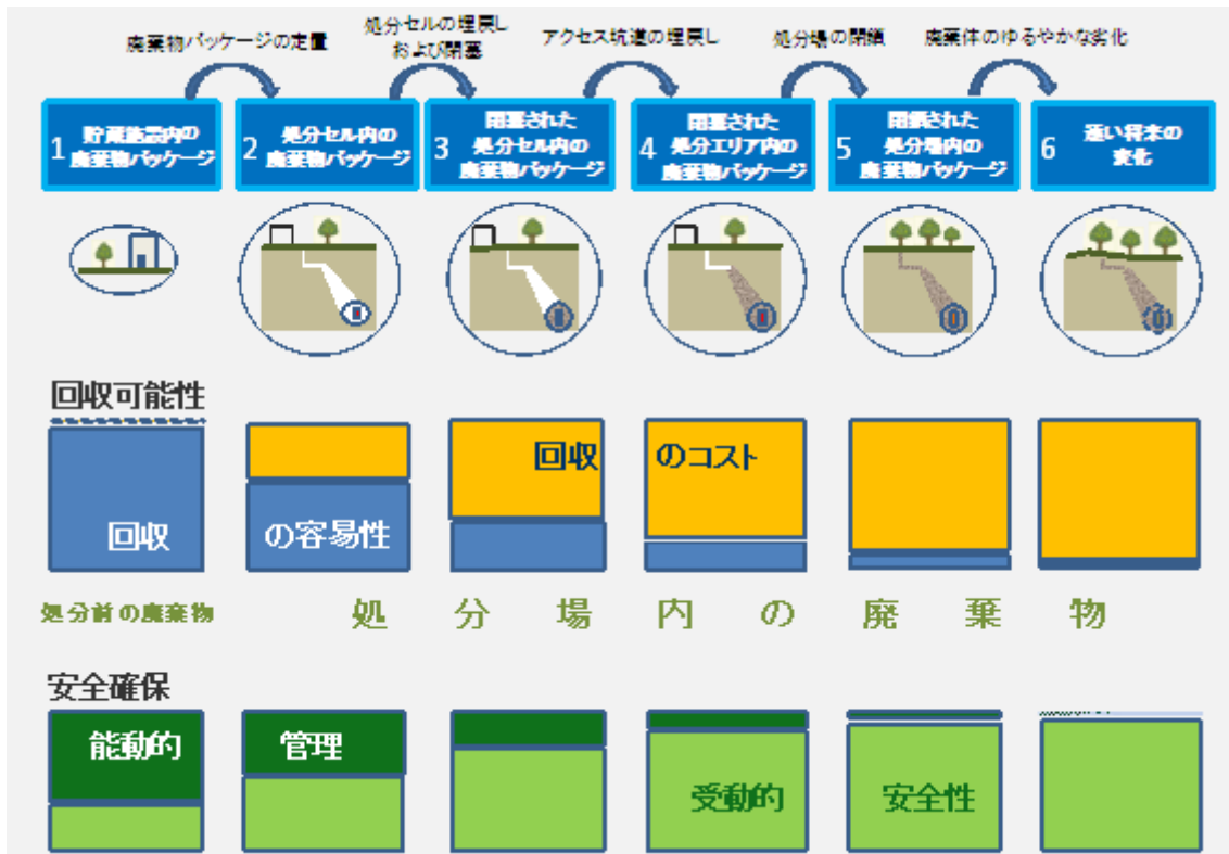
図 3: 「R スケール」: 廃棄物の事業段階、深地層処分場の回収可能性の程度、受動的な管理か能動的な管理か、回収コストの変化を図示したもの。作業段階の間は、処分施設内にあるすべての廃棄物パッケージが、事業の同じ段階にあるとは限らない。
