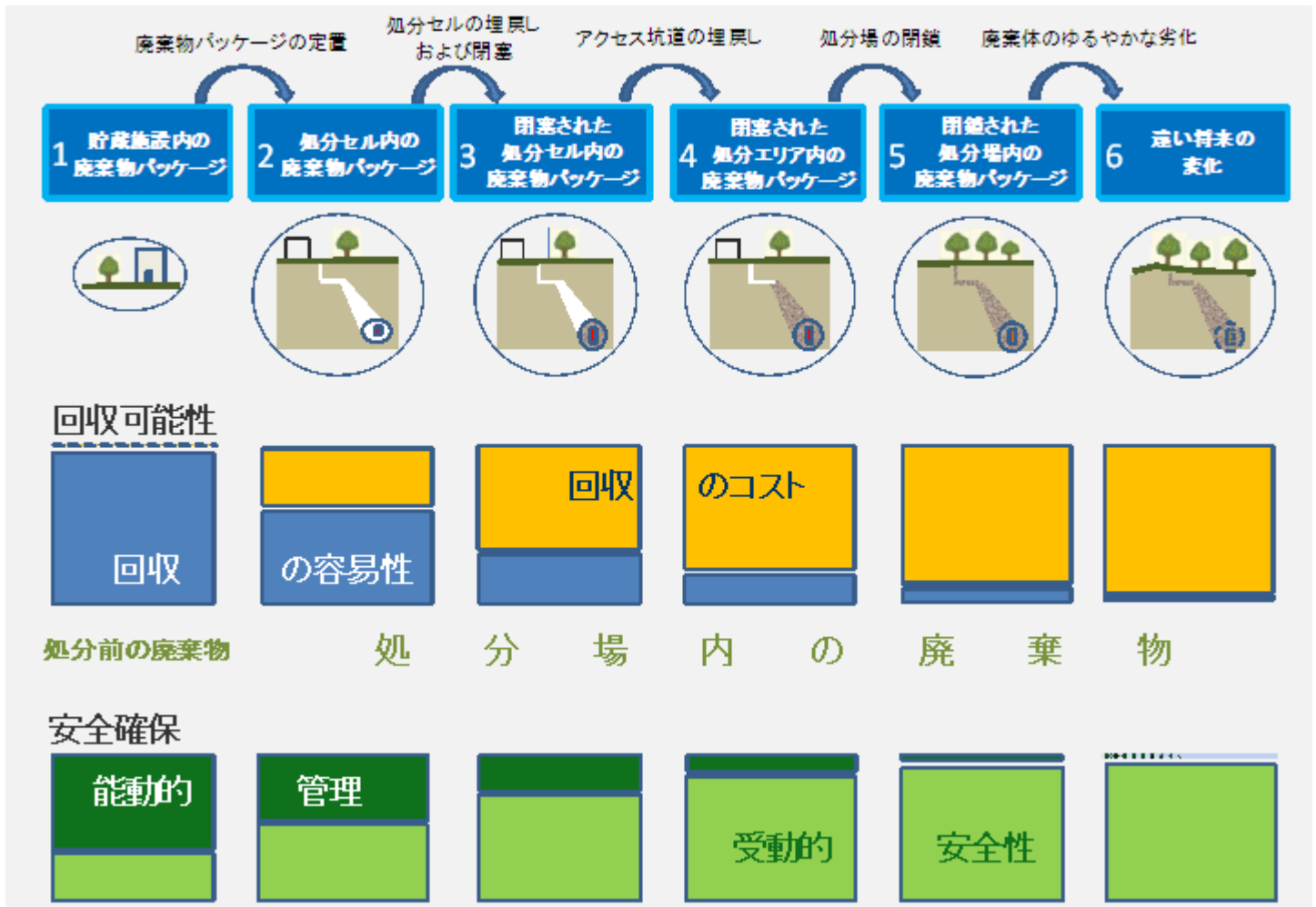
図4 廃棄物のライフサイクル段階、深地層処分における回収可能性の程度、受動的安全性か能動的な管理か、回収コストの変化を図示したもの。操業段階の間は、処分施設内にあるすべての廃棄物パッケージが、ライフサイクルの同じ段階にあるとは限らない。注意：図示された四角形の正確な比率は、処分場の設計によって変わる。
