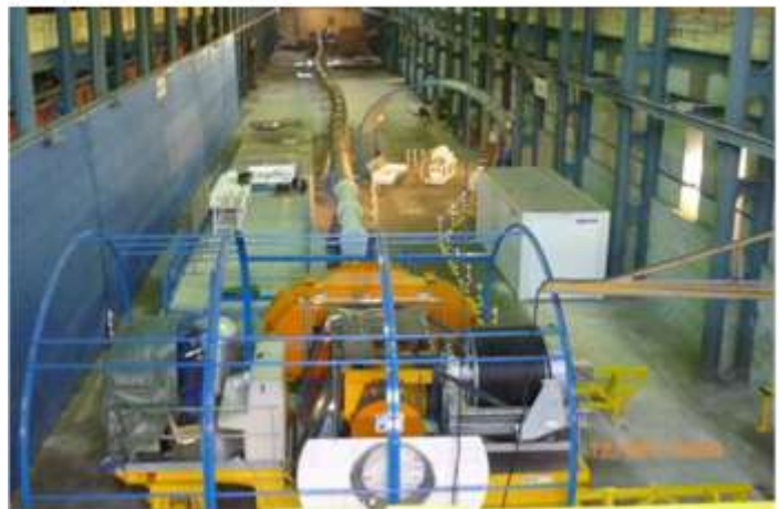
図3b: フランスで実施された模擬処分坑道を使用した高レベル廃棄物の回収試験(ESDRED programme, 2008)
