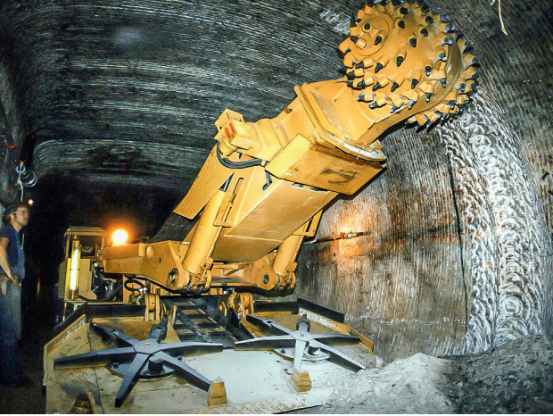
地下で撮影した連続採掘機。 米国エネルギー省
